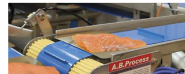
Immagine 18: Installazione speciale di mototamburo in un'area sottoposta a lavaggi
