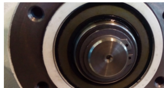
Immagine 16: Lato esterno anello di tenuta radiale del motoriduttore
