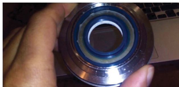
Immagine 17: Lato interno anello di tenuta radiale del mototamburo. L'anello bianco in posizione posteriore è la tenuta igienica lato prodotto.
